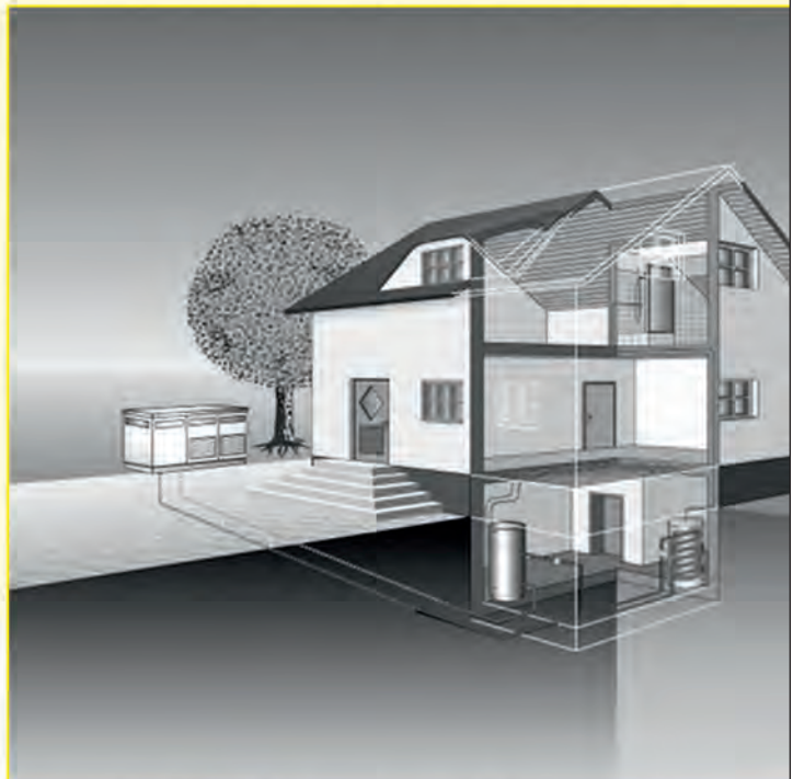
Prinzipielle Darstellung der Funktionsweise einer Luft-Warmwasser-Wärmepumpe
